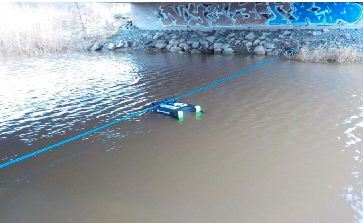
Virtaamamittausta Hirvijoella Turku-Kustavi maantiesillalla 1.12.2020 (kuva: Pasi Salmi).
